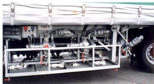
Installation sur remorque de trois pompes volumétrique en entraînement hydraulique
